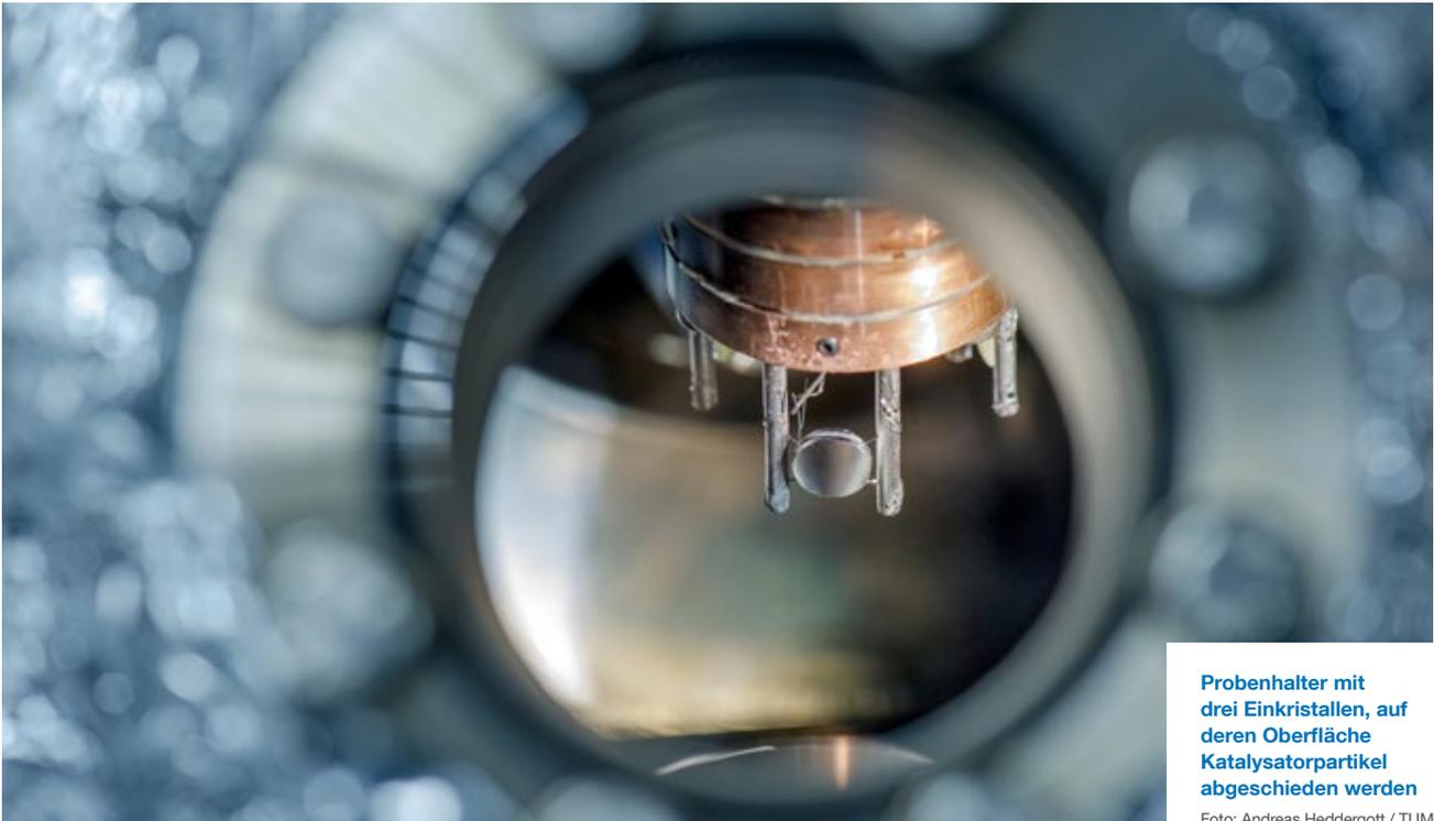
Probenhalter mit drei Einkristallen, auf deren Oberfläche Katalysatorpartikel abgeschieden werden
